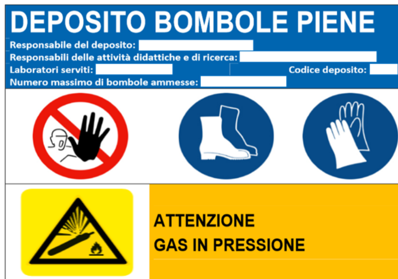
Figura 6 - Segnaletica per deposito bombole
